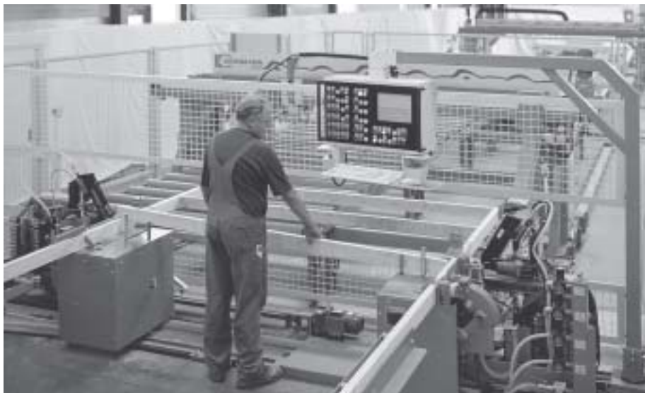
Abb. 7.6: Mechanisierte Fertigung Holzriegelkonstruktion für Tafелеlemente
