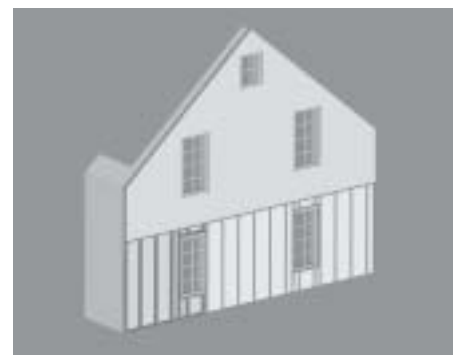
Abb. 7.8: 3-D-Darstellung von Fassadenmodulen mit Unterkonstruktion, Dämmung und Bekleidung
